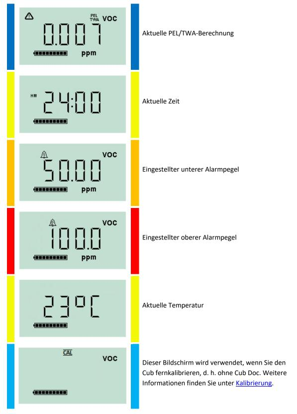
Beachten Sie, dass der Cub so konfiguriert werden kann, dass nur bestimmte Bildschirme angezeigt werden (siehe Abschnitt Gerätekonfiguration).
