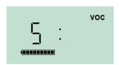
Drücken Sie die Multifunktionstaste, um zum Prüfgas zu schalten. Der Bildschirm zeigt ein "S" an.
