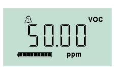
Wenn die erkannte Gaskonzentration einen Alarm mit hohem Level auslöst, blinken der Bildschirm und die Lampen auf der Geräteoberseite rot.
