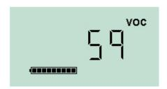
Der Bildschirm wechselt und zeigt den aktuellen Messwert des Sensors an. *Diese Zahl bezieht sich nicht auf die Gaskonzentration,* sondern weist nur darauf hin, dass der Sensorausgang sich verändert.
