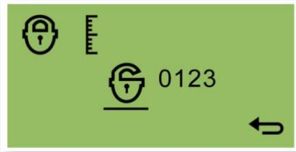
在「锁定/解锁」画面上，使用开关 2 切换锁定和解锁校准。
