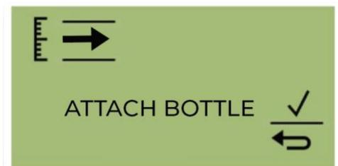
在开始校准之前安装瓶子。这可确保在校准开始之前苯流经 Titan 2 系统。
