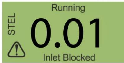
如果出现故障，主屏幕将显示警告画面，并在警告图标下提供故障名称。
