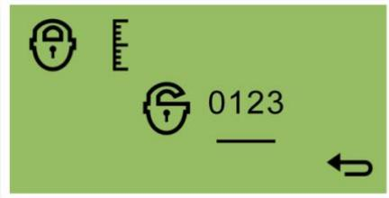
要更改密码，请使用开关 1 导航至密码图标，然后使用开关 2 进行选择。
