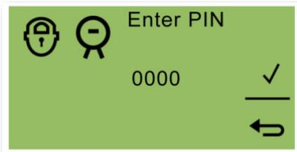
在「输入密码」画面中，使用开关 2 转换数值以设置首个数位。然后使用开关 1 移至下一数位。
