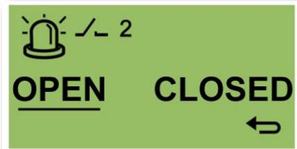
在继电器测试画面中，在开启 (OPEN) 和关闭 (CLOSED) 之间切换，以手动操作继电器。
