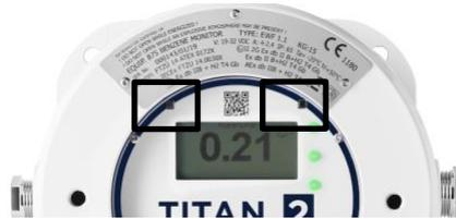
三枚 LED 灯将同时运作，并将显示相同颜色。
