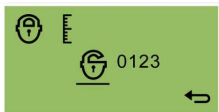
Sur l'écran « Verrouiller/Déverrouiller », utilisez le commutateur 2 pour basculer entre le verrouillage et le déverrouillage de l'étalonnage.
