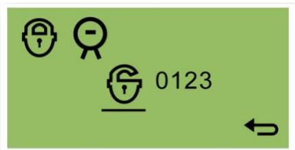
Sur l'écran de verrouillage/déverrouillage utilisé l'interrupteur 2 pour passer du verrouillage au déverrouillage de l'affichage.
