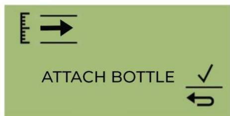
Fixez la bouteille avant de commencer l'étalonnage. Cela garantit que le benzène circule dans le système Titan 2 avant le début de l'étalonnage.
