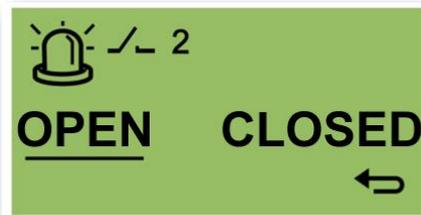
Sur l'écran de test du relai, basculez entre OUVERT et FERME pour opérer les relais manuellement.
