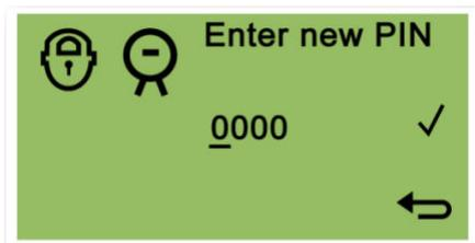
Sur l'écran "Enter new PIN", utilisez l'interrupteur 2 pour parcourir les valeurs pour régler le premier chiffre. Utilisez l'interrupteur 1 pour se déplacer au prochain chiffre.
