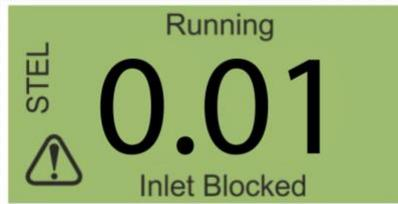
S'il y a une défaillance, l'écran principal change en un écran de warning et donne le nom de la défaillance sous l'icône de warning.
