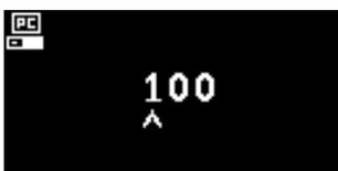
Utilisé pour sélectionner une adresse esclave Modbus.
