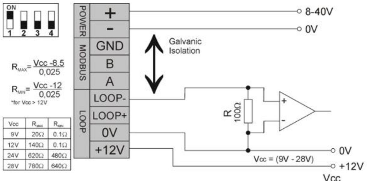
Configuration de boucle de courant Falco 3 – boucle de courant passive, source de courant alimentée en externe
