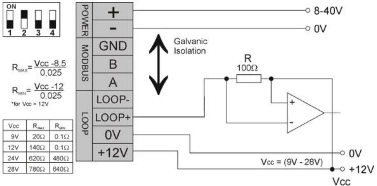
Configuration de boucle de courant Falco 2 – boucle de courant passive, source de courant alimentée en externe.
