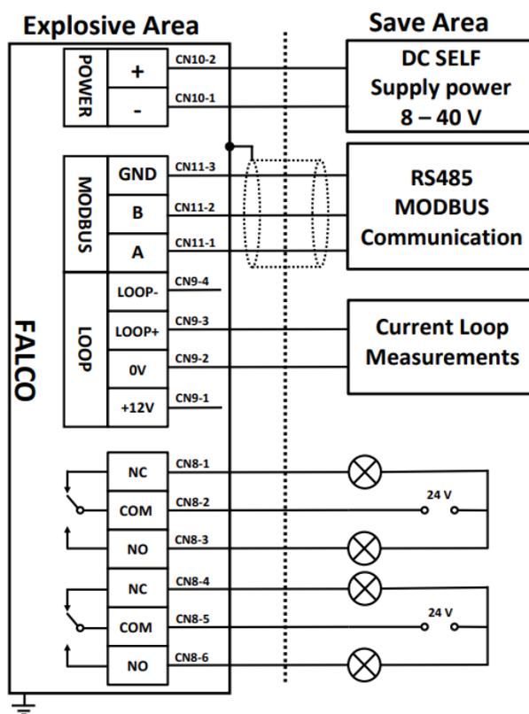
Figure montrant un schéma de câblage de connecteur typique.
