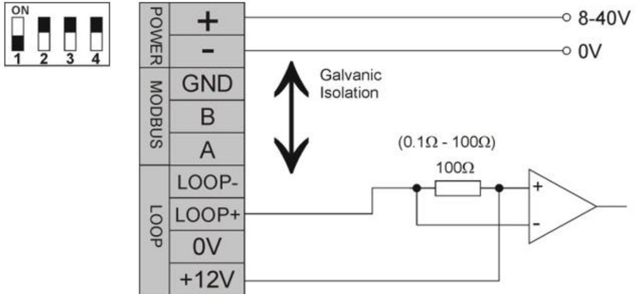
Configuration de boucle de courant Falco 4 – boucle de courant active, utilisant une alimentation interne connectée à la source de courant.
