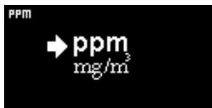
Permet de modifier les unités de détection par défaut de ppm en milligrammes par mètre cube (mg/m3).
