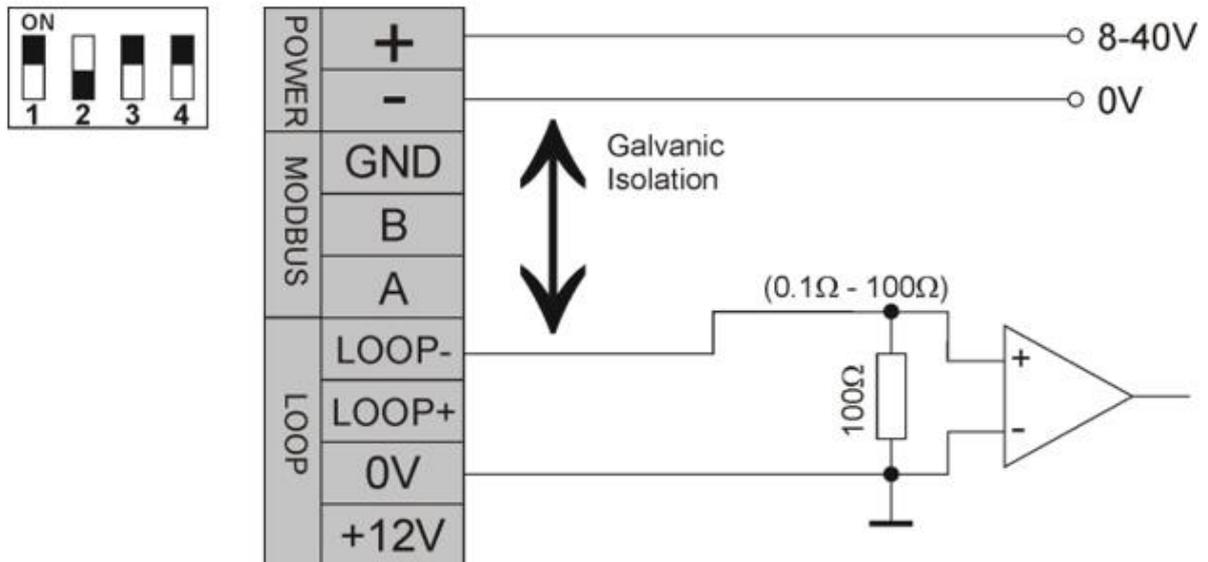
Configuration de boucle de courant Falco 1 – boucle de courant active, utilisant une alimentation interne connectée à la source de courant.
