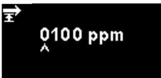
O limite inferior do O intervalo de saída de 4 mA a 20 mA, mapeado para 4 mA, é de 0 ppm. Esta opção é utilizada para definir o limite superior, mapeado para 20 mA.
